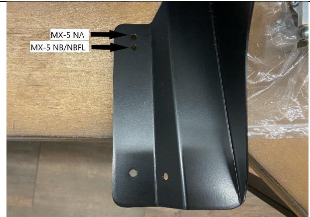
Verwendung des hinteren Befestigungsloches in Abhängigkeit vom Fahrzeug
