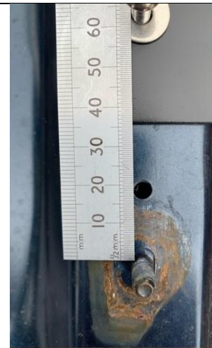
Abstandsmessung als grobe Richtungsvorgabe, anschließend den Spoilerfuß an der hinteren Bohrung zwischen den bereits vorhandenen Löchern ausmitteln
