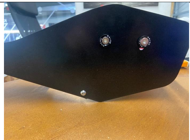
Spoilerbrett an Spoilerfuß befestigt
